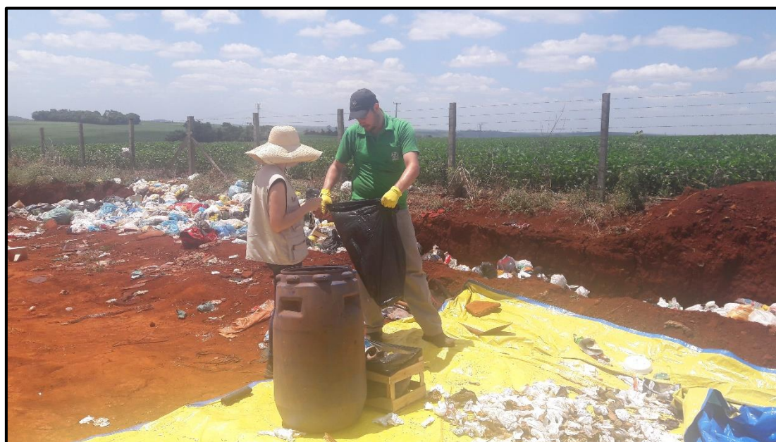
Figura 37: Segregação dos resíduos conforme a tipologia para a realização do estudo da composição gravimétrica dos resíduos gerados no município de São Pedro do Iguaçu/PR
