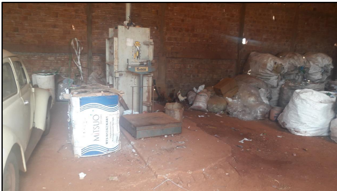
Figura 31: Prensa e balança do barracão particular de triagem de resíduos recicláveis localizado no município de São Pedro do Iguaçu/PR
