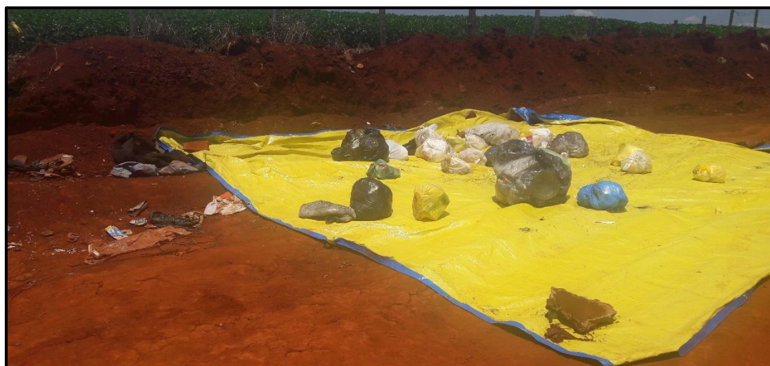
Figura 35: Coleta de sacolas para que servissem de amostra para a realização do estudo da composição gravimétrica dos resíduos gerados no município de São Pedro do Iguaçu/PR
