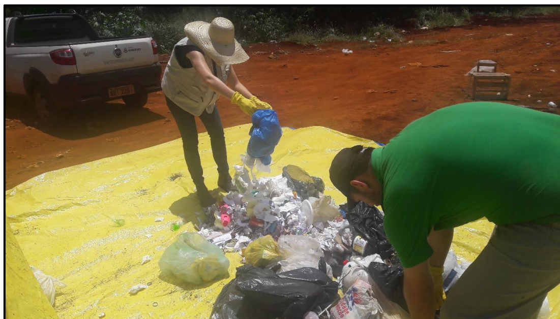
Figura 36: Processo de abertura de sacolas para a realização do estudo da composição gravimétrica dos resíduos gerados no município de São Pedro do Iguaçu/PR
