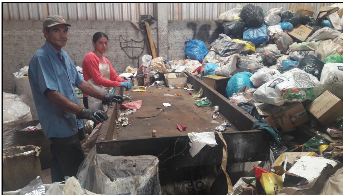
Figura 54: Mesa localizada no barracão de triagem da ASCARMAT para realizar a segregação dos resíduos recicláveis advindos da coleta seletiva do município de Matelândia/PR
