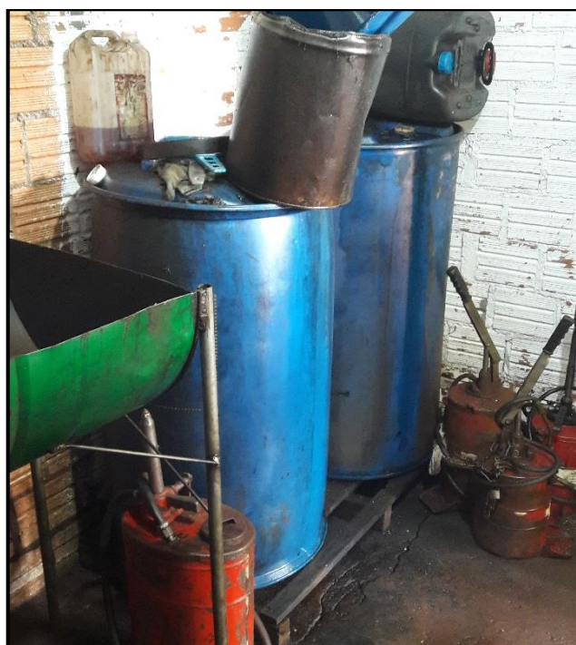
Figura 96: Bombonas de armazenamento temporário de óleos lubrificantes usados, localizadas no pátio da Secretaria de Obras da Prefeitura Municipal de Vera Cruz do Oeste/PR
