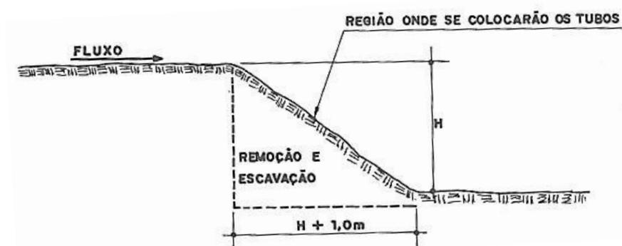
**Figura 105 – Degrau com tubos – perfil longitudinal da voçoroca.**
