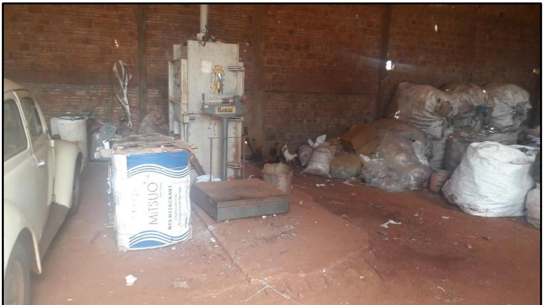
**Figura 31: Prensa e balança do barracão particular de triagem de resíduos recicláveis localizado no município de São Pedro do Iguaçu/PR**
